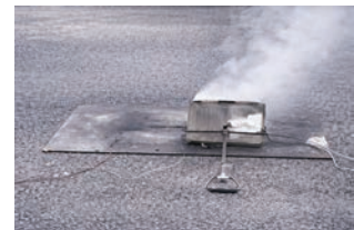
③ 장치 내부에서 소화 패드가 작동하여, 화염 확산을 방지하고, 연기만 발생한 상태에서 화재가 진화 됩니다.
